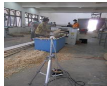
Gb.5 pengukuran kadar debu pada proses pengetaman dengan mesin ketam perata/ surface planner dan ketam penebal/ thicknicer
