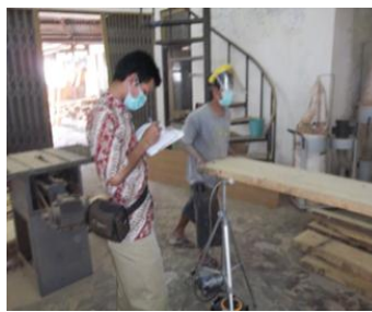
Gb.4 pengukuran kadar debu pada proses pemotongan/pembelahan dengan gergaji sirkel/ circular saw
